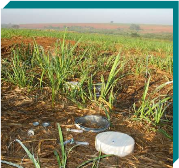
Figura 2: Experimento para determinação de fatores de emissão de N 2 O no cultivo de cana-de-açúcar.
