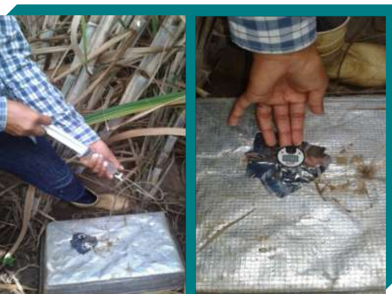
Figura 1: Medição do fluxo de N 2 O pelo método da câmara estática fechada.
