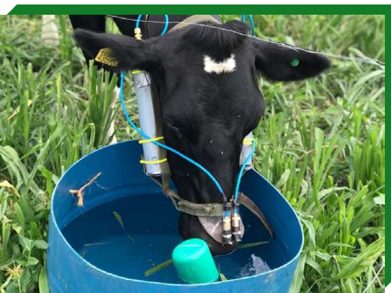
Figura: Medida da emissão de \text{CH}_4 de origem entérica utilizando a técnica do hexafluoreto de enxofre ( \text{SF}_6 ) em vacas leiteiras pastejando capim-milheto
