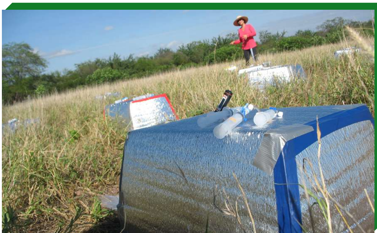
Figura: Câmara de monitoramento das emissões de gases de efeito estufa no solo em área de capim Buffel.
